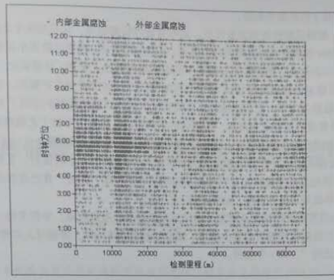
图5 A段腐蚀缺陷沿时钟方位和检测里程分布图
