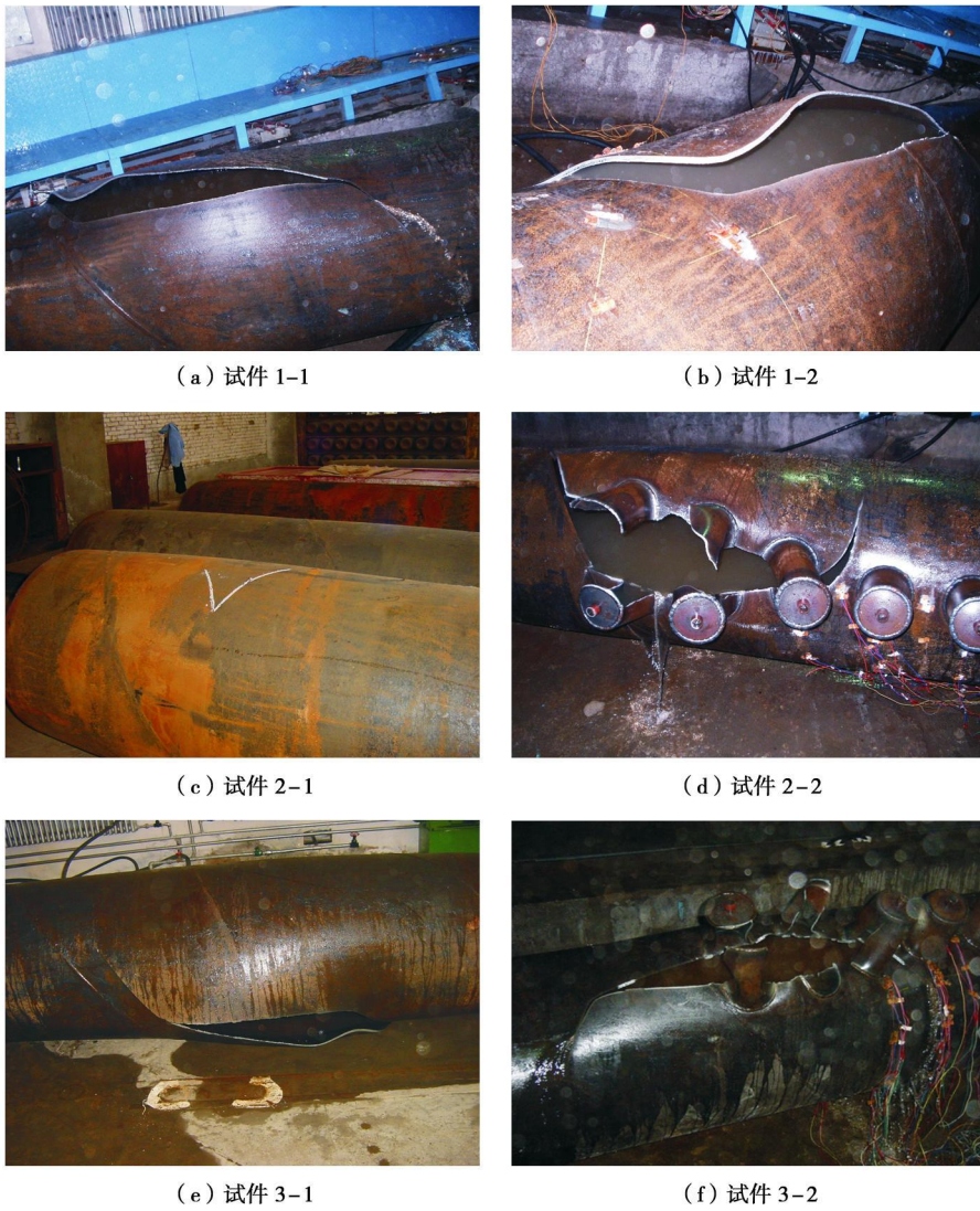
图 1 试件断裂与鼓胀情况
